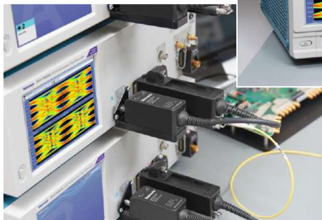
DPO70E 系列光學探棒，使用 70 GHz DPO70000SX 系列示波器上的 ATI 通道
