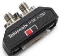
P76CA-292 附 2.92 公釐 (母) 接頭的 33 GHz 頻 寬同軸轉接器。此轉接器在輸入接 頭處進行了校準，非常適合與現成 或自訂電纜一起使用。應使用低偏 斜電纜對來保持完整頻寬效能。
