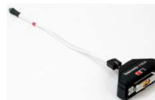
P76TA 30 GHz 頻寬 P7500 探棒頭轉接 器。當此轉接器與 P75PST 高效 能焊接探棒頭一起使用時，探棒 和示波器系統將支援高達 30 GHz 的頻寬。
